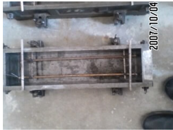
(d) Short beam control and fiber beam rebar's
